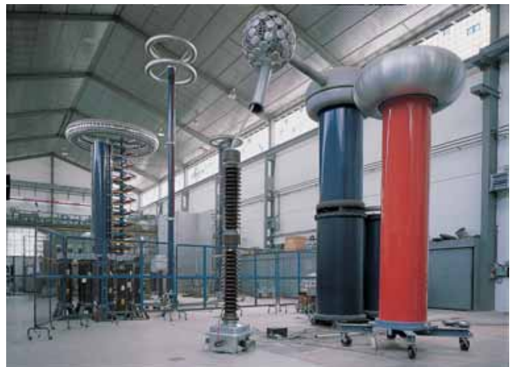
Test de rutina a Transformador de tensión de 245 kV.
